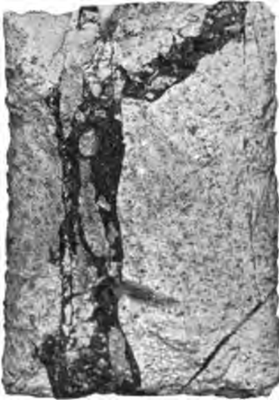
Breccienstruktur. Fig. 8. Einfacher Goldgang mit viel Nebengesteinsbruchstücken im Trachyt von Nagyag.
